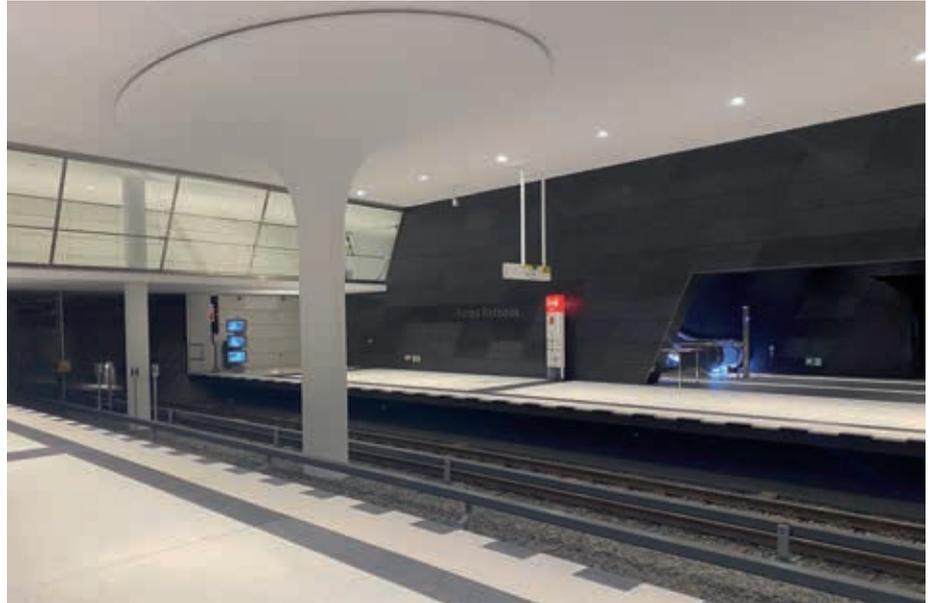
*U-Bahnhof Rotes Rathaus: Auf den lastabtragenden „Pilzkopfstützen“ aus Beton ruht die Stationsdecke.*
