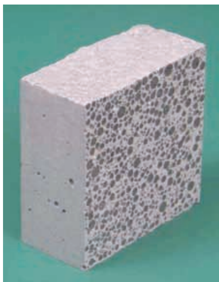
Abbildung 1 Infraleichtbeton [Dr.-Ing. Alex Hückler, TU Berlin]
