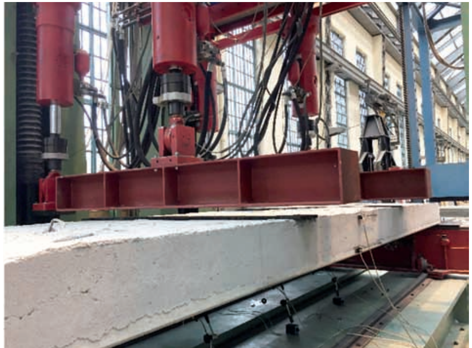
Abbildung 3 Versuchsaufbau des Vier-Punkt-Biegeversuchs
