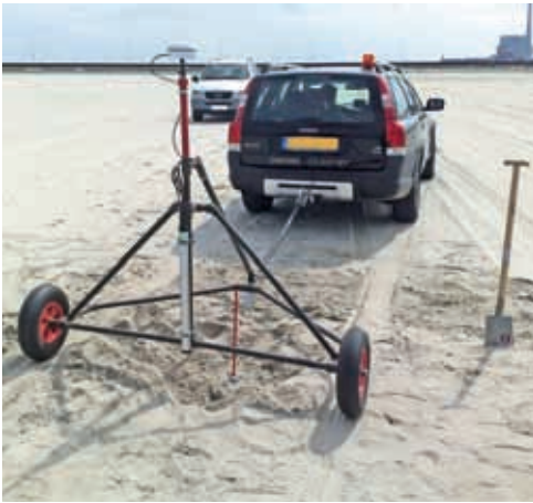
Einsatz von Sonden der Magnetik als Oberflächentechnik mit einem Fahrzeug
