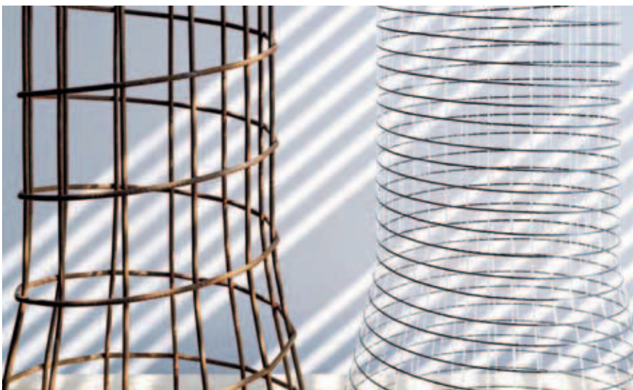
Bewehrung aus Stahl (links) und sensorischem Textilgitter (rechts) für ein Betonrohr.
