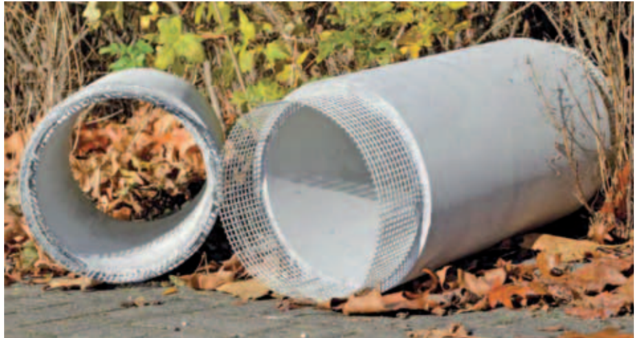
Textilbetonstrukturen mit integrierter Leckagesensorik.
