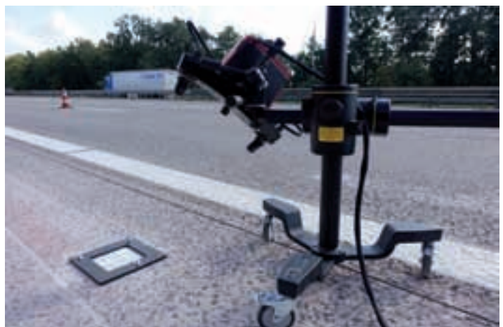
Abbildung 2: 3D-Aufnahmen mit dem Streifenlichtprojektionssystem auf der BAB A10 bei Berlin
