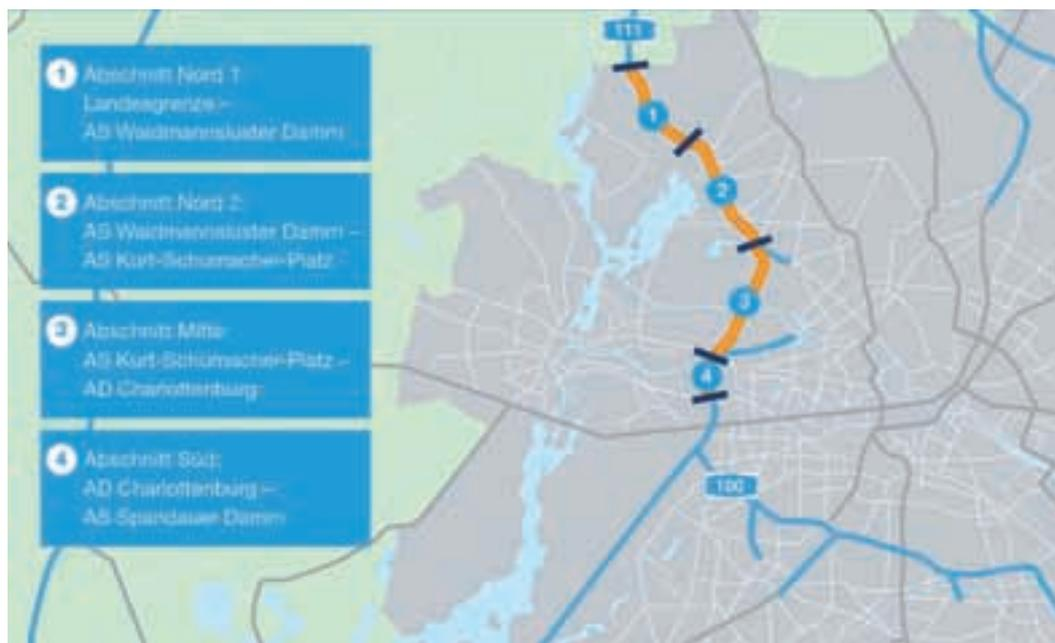
Das integrierte Bau- und Verkehrskonzept sieht vier Bauabschnitte für die Grundsanie rung der A 111 vor. Zur Verkürzung der Bauzeit soll immer in zwei Abschnitten parallel gearbeitet werden.
